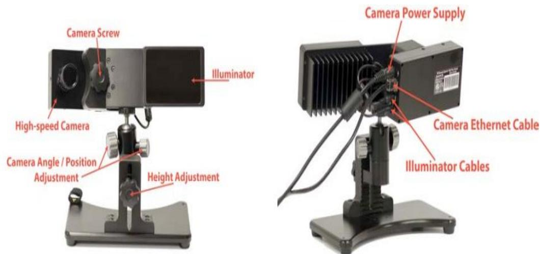
眼动跟踪软件使用图像处理算法来识别眼睛跟踪相机发送的每个图像上的两个关键位置—瞳孔中心和角膜反射中心。角膜反射点是固定光源（红外照明器）的发出的光在角膜上反射回来的点，如下图所示。
