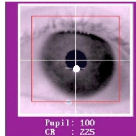
眼动仪相机拍到的瞳孔和角膜反射点
